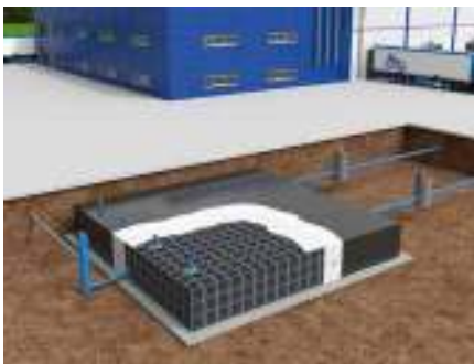
Speicher- oder Retentionssystem mit D-Raintank 3000® und anschließender Folienummantelung mit vorgeschalteten Reinigungsschächten und nachgeschaltetem Überlaufschacht für die dauerhafte Speicherung von Regenwasser.
