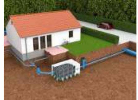
Versickerungssystem mit D-Raintank 3000® im Strang verlegt sowie mit vorgeschaltetem Reinigungsschacht und nachgeschaltetem Drosselschacht. Die Verbindungen bestehen aus HS®-Rohren für Regenwasser.
