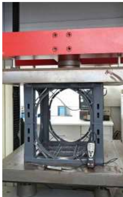
Kurzzeitversuch mit vertikaler Belastung
