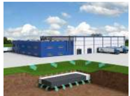
Gewerbliche Flächen können durch D-Raintank 3000® auch auf kleinstem Raum entwässert werden, z. B. in der Variante als Muldenrigole.
