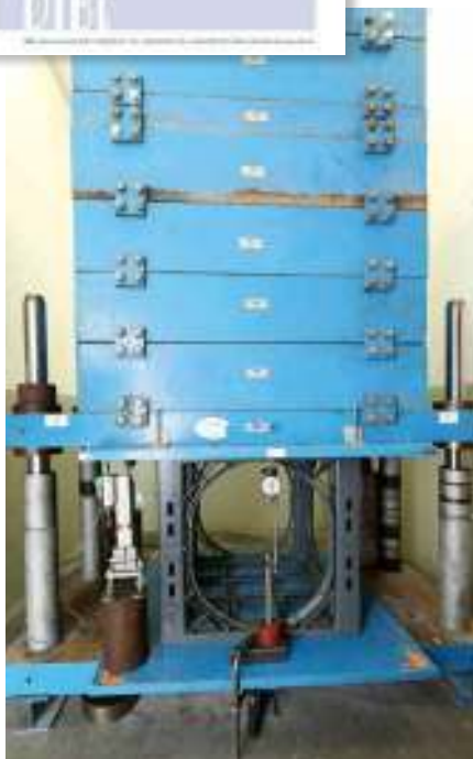
Langzeitversuch mit vertikaler Extrembelastung
