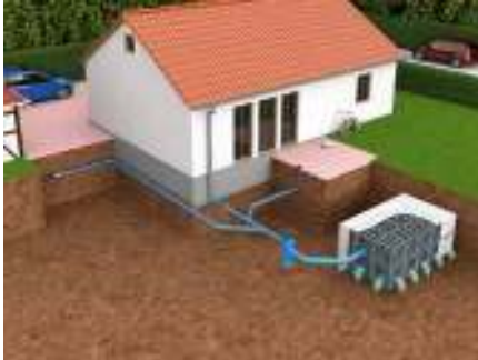
Versickerungssystem mit D-Raintank 3000® im Strang verlegt und mit vorgeschaltetem Reinigungsschacht. Die Verbindungen bestehen aus HS®-Rohren für Regenwasser.
