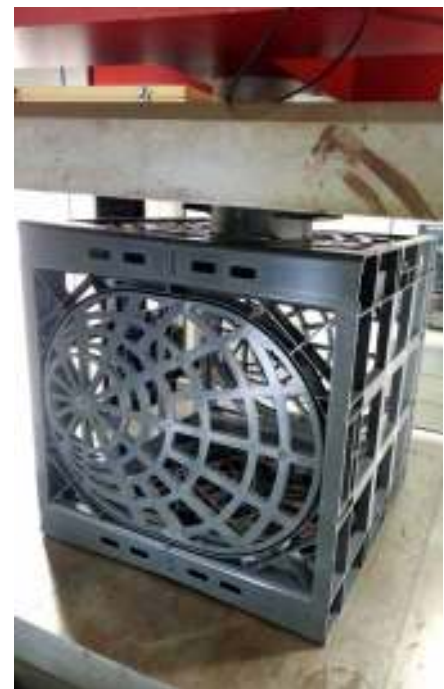
Druckbelastung der Seitenplatte über Stempel
